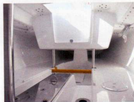
Das Vorschiff bietet viel Platz für eine Dreieckskoje, achtern sind die Auftriebskörper gleich als Kojen ausgeformt. Im Vordergrund der aufholbare Hubkiel
